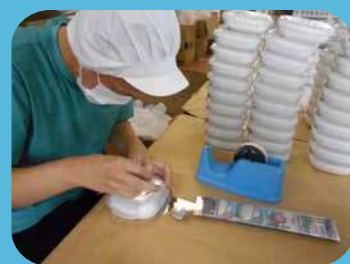
<プラスチック製品のシール貼り>
